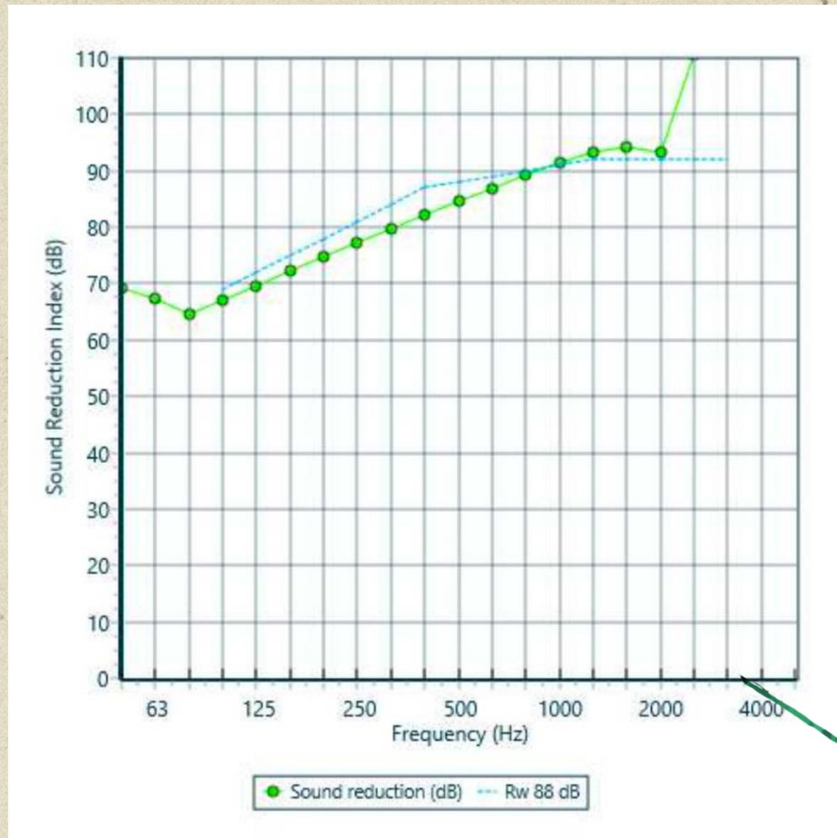
Prevediamo un intervento di insonorizzazione della struttura attraverso la coibentazione acustica del tetto con pannelli isolanti. Questi sono realizzati con materiali a massa elevata e contengono spazi d'aria riempiti con materiali assorbenti.
